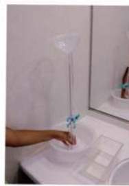
透度計の上にロートを置き、受け皿も置き
